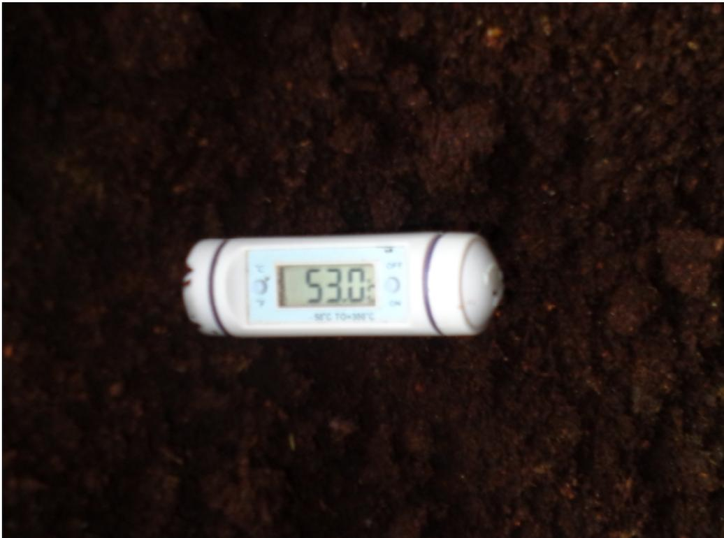
Figura 10: Realização da medição da temperatura da cama.
