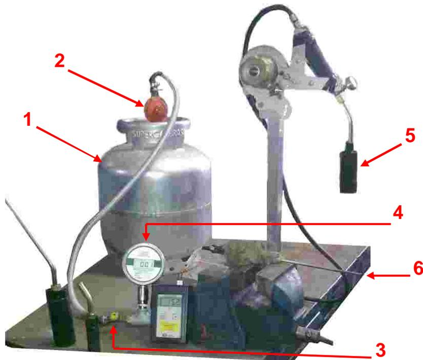
Figura 1 – Bancada de testes, onde: 1) botijão GLP 13 kg; 2) válvula; 3) registro; 4) manômetro; 5) queimador; 6) termopar.
