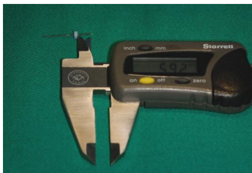
Figura 4 - Paquímetro digital averiguando a medida do cursor.
