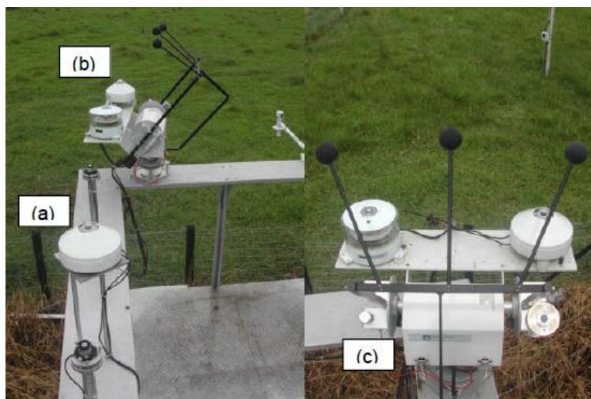
Figura 2 - Sensores de radiação solar global (a), difusa (b) e rastreador solar (c). Fonte: Aguiar et al. (2011), p.18.
