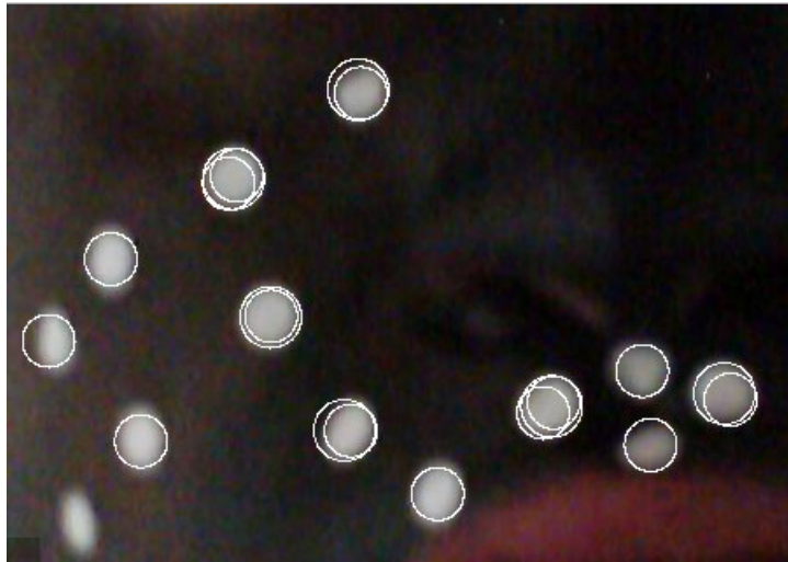
Figura 4.9: Resultado da aplicação do algoritmo de identificação de círculos de uma imagem humana real com os pontos de controle brancos e com face pintada de preta.
