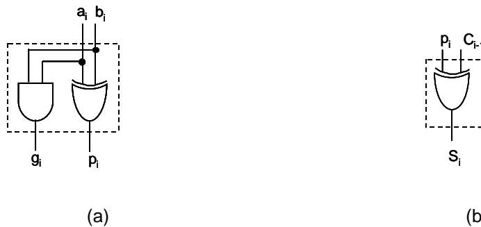
Figura 27 – Circuitos lógicos para a geração dos sinais auxiliares, Carry Generate e Carry Propagate (a) e soma (b) para o i -ésimo estágio
