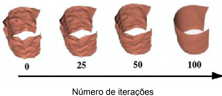
Figura 13 – Aplicação do algoritmo de suavização Laplaciana.
