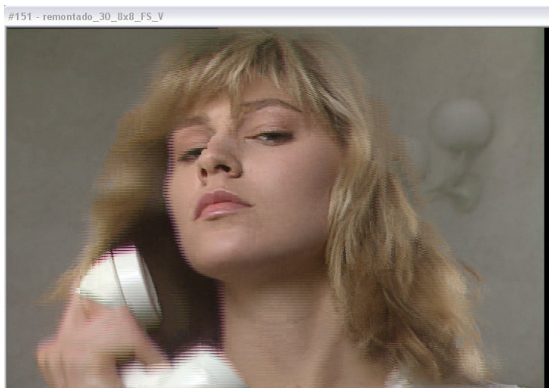
Figura 4.4 – Quadro remontado com blocos de 8x8 pixels.
