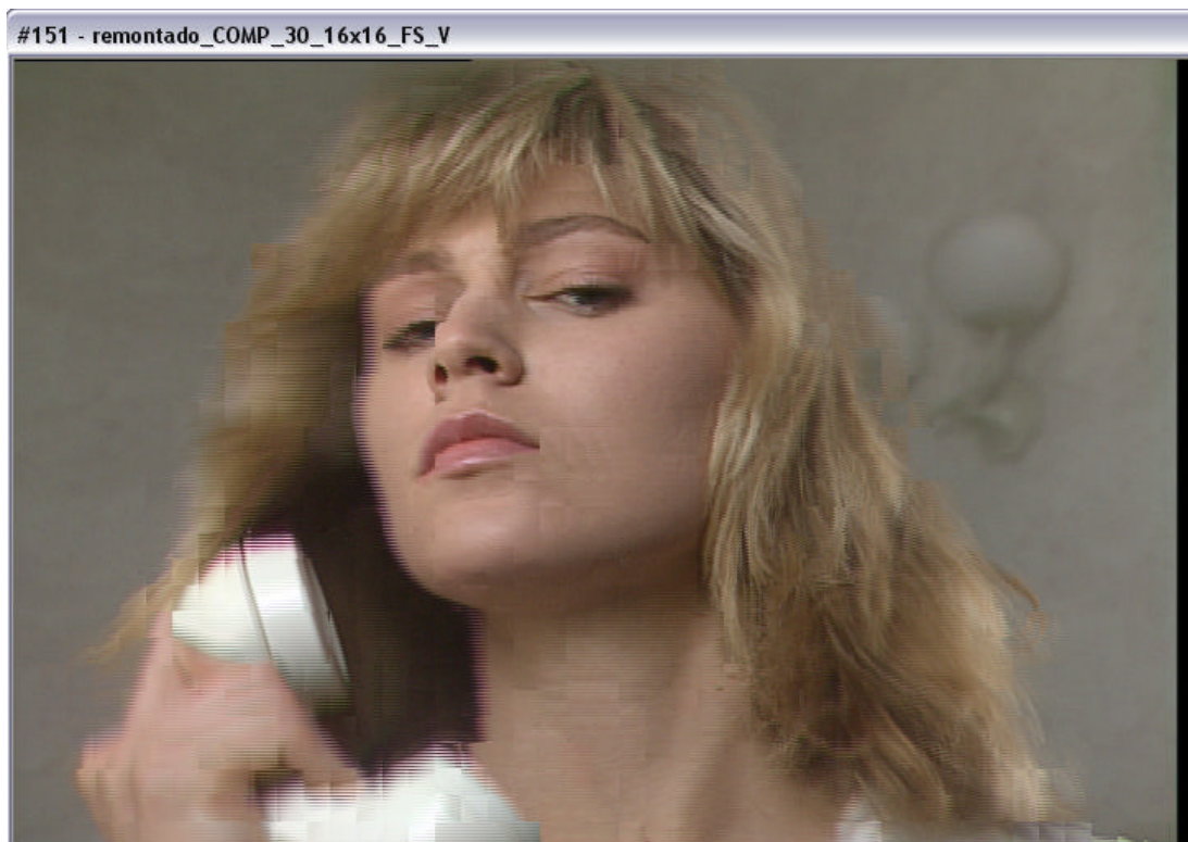
Figura 4.2 – Quadro remontado com blocos de 16x16 pixels.
