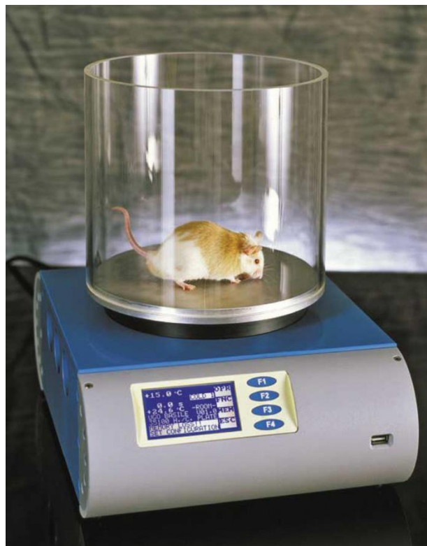
Figura 5. Representação do equipamento utilizado no experimento da chapa quente.
