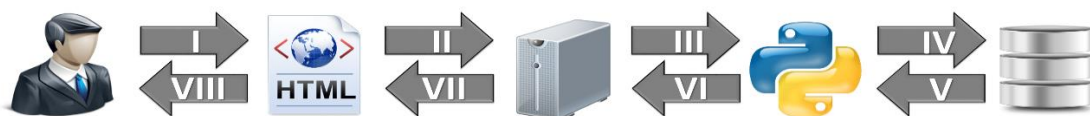
Figura 1. Representação do fluxo de informação durante uma consulta no banco de dados. (I) Interação com site. (II) Envio das requisições para o servidor via formulário POST. (III) Passagem das requisições para scripts CGI escritos em linguagem Python através do módulo mod_python rodando em um webserver Apache HTTP . (IV) Consulta no banco de dados mongo feita pelos scripts CGI . (V) Retorno dos dados solicitados. (VI e V) envio da resposta gerada pelo CGI a partir dos dados resultantes da busca. (VII e VIII) Apresentação dos dados na forma de uma página resposta.
