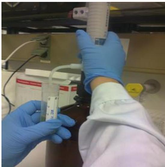
Figura 6: Preparo final de amostra através da adição de água Milli-Q para análise em espectrometria de massas.
