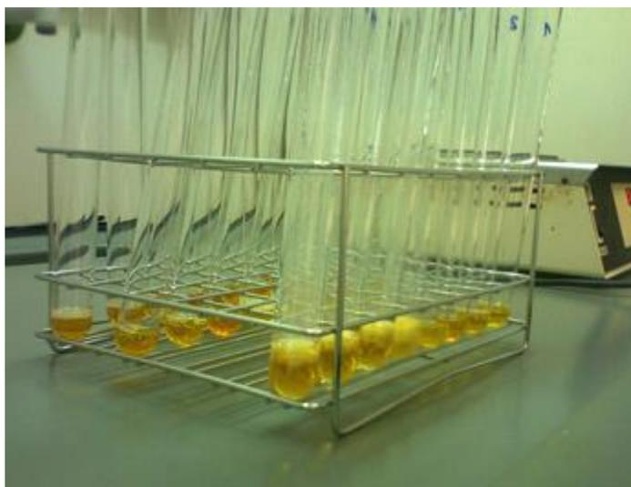
Figura 4: Observação da formação de grumos em preparação de amostra para análise em espectrometria de massa.
