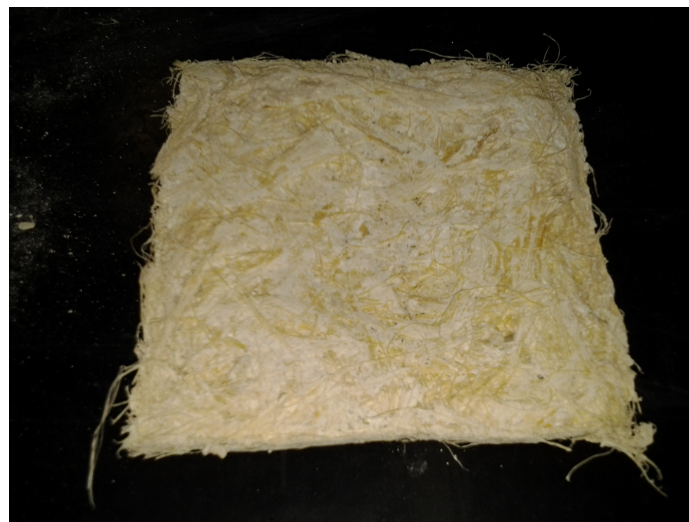
Figura 2 – Corpo de prova com 50% de feixes de fibras obtidos a partir de talos da banana do gênero " musa cavendishi ", seco em estufa, por 12 horas, à temperatura de 50°. C..
