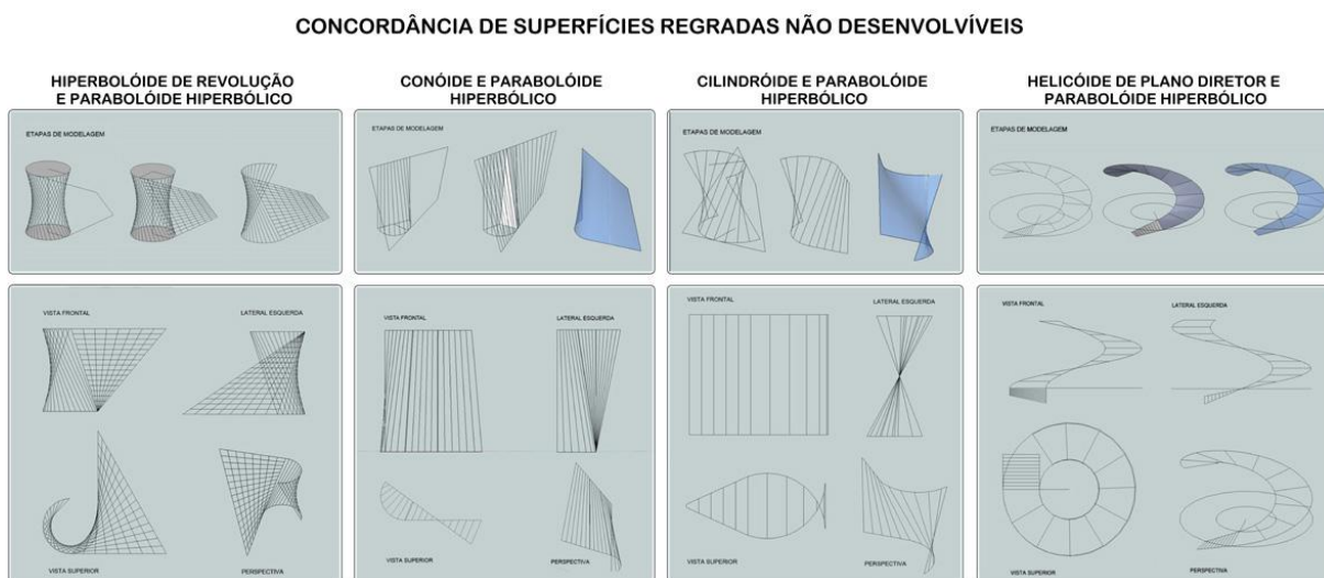
Figura 2 – Resultado dos exercícios de concordância entre tipos de superfícies regradas não desenvolvíveis: Na imagem superior: ilustração das etapas do processo de modelagem; na imagem inferior: vistas ortográficas e perspectivas. Fonte: Medeiros, Pires e Nunes, 2012.
