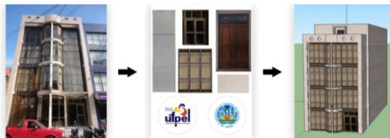
Figura 03 – À esquerda, foto do Edifício da Engenharia dos Materiais/UFPel; Ao centro, elementos editados para compor a textura; à direita, modelo digital tridimensional. Fonte: XAVIER, Pamela, 2012
