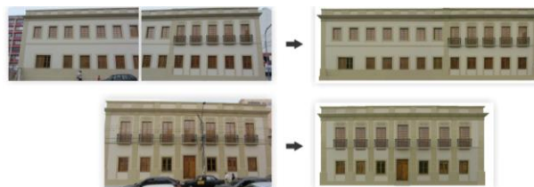
Figura 04 – Edição feita através da reprodução da fachada a partir de uma única imagem, utilizada no modelo do ICH Campus 5 (Prédio da Geografia) Fonte: XAVIER, Pamela, 2012.
