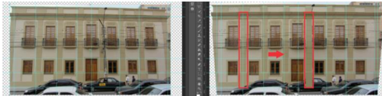
Figura 05 – Exemplo do ajuste de perspectiva com linhas guias e inserção de textura sobre interferência.
