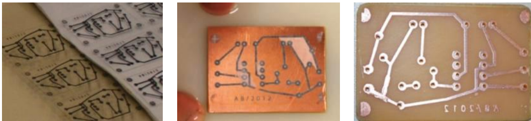
Figura 3: (a) impressão sobre transparência, (b) transferência do desenho para a PCI a partir da impressão das “trilhas” sobre papel couchê e (c) circuito gravado na PCI
