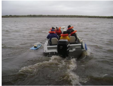
Figura 2 – Campanha de medição de correntes no Canal São Gonçalo, utilizando ADCP.
