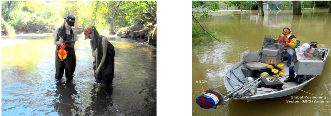
Figura 5 – Medição de vazão utilizando molinete (esquerda) e utilizando ADCP (direita).
