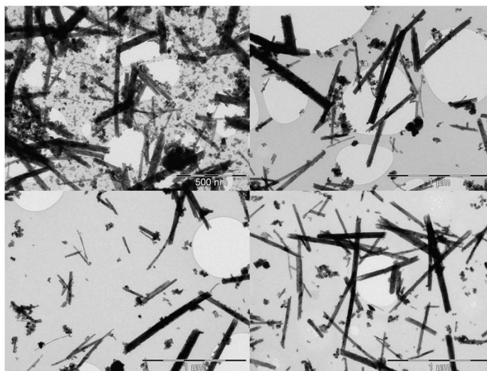
Figura 2: Micrografias de MET de nanofitas de CGO em tempos de a) 2 min; b) 4 min; c) 8 min e d) 16 min.
