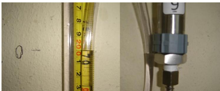
Figura 2 - Nivelamento para obtenção do padrão de pressões.
