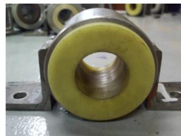
Figura 4 – Nylon 6.0 auto lubrificante.
