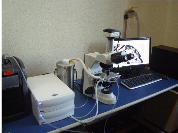
Figura 1: Sistema Linkam THMS600 com LNP95.
