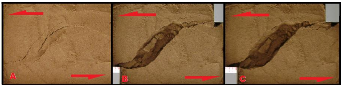
Figura 3: Imagem do experimento realizado na sandbox apresentando as feições estruturais desenvolvidas com o avanço da deformação. A: feição observada após 5 mm de deslocamento. B: feição observada após 2,5 cm de deslocamento. C: deformação máxima observada, após 5 cm de deslocamento.
