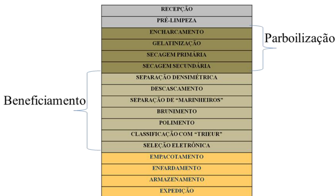
Figura 1: Fluxograma do Processamento de Arroz Parboilizado
